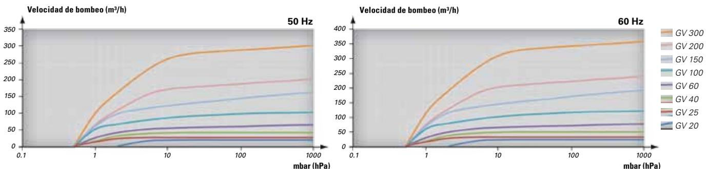
Rendimiento de la bomba medido a la presión de entrada y 20 °C. Precisión: +/- 10%.
